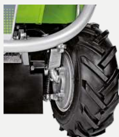
Particolare protezioni antierba
