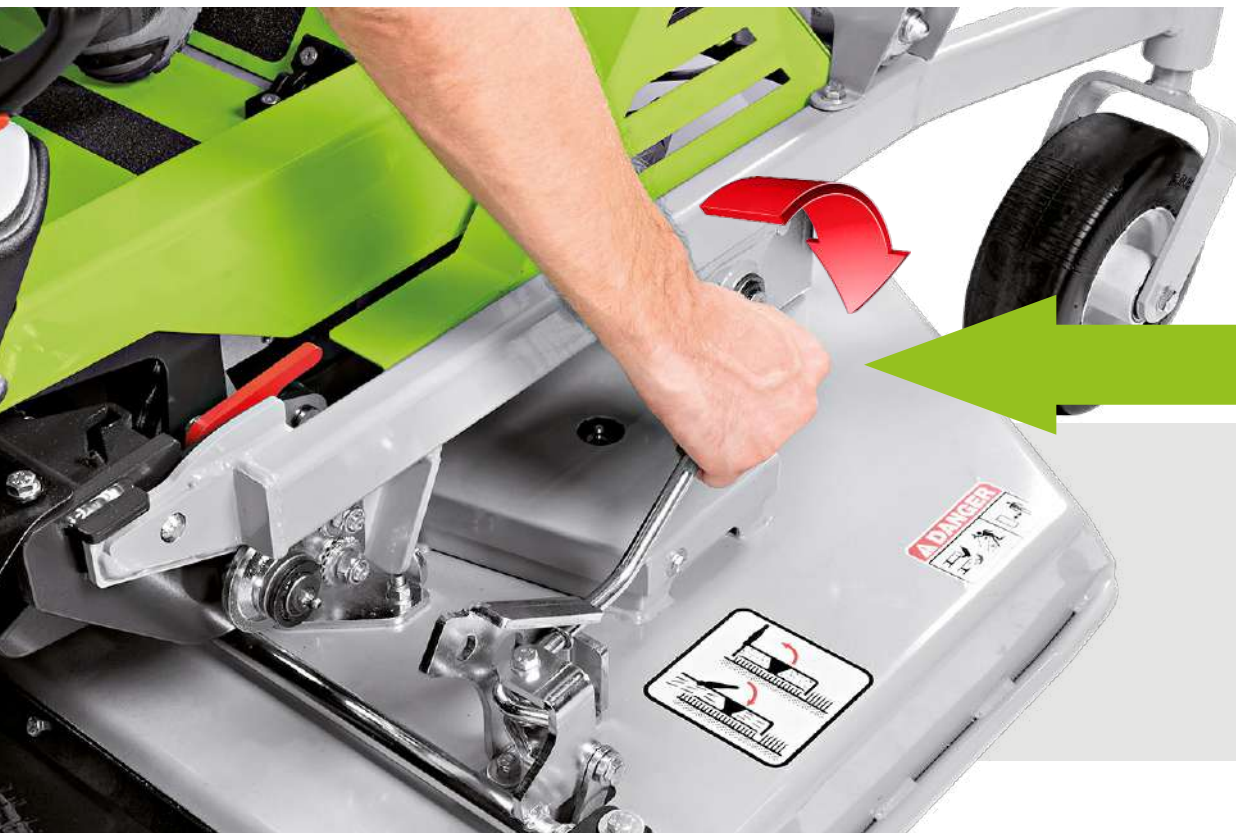
A TAGLIO SCARICO POSTERIORE CAMERA DI TAGLIO APERTA
