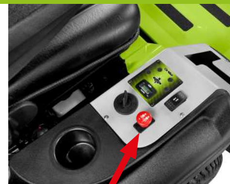
Frizione elettromagnetica per innesto lame.
